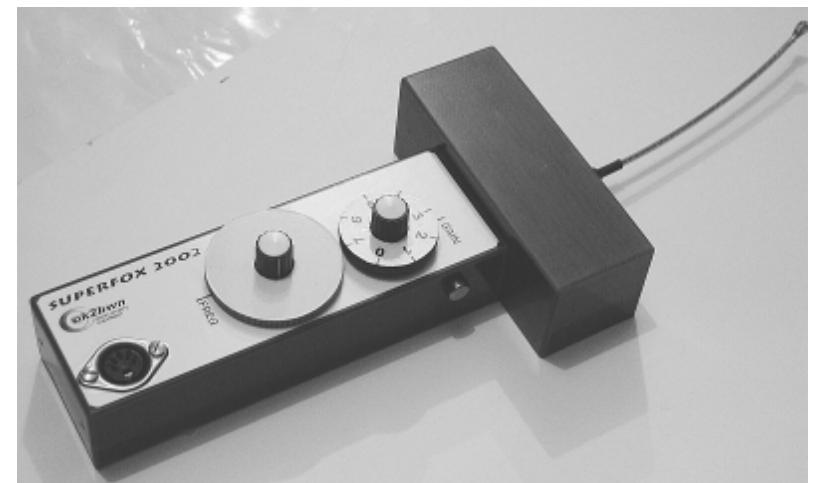
ZAMĚŘOVACÍ PŘIJÍMAČ PRO ROB 3,5 MHz
