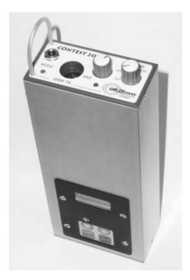
HF/VHF AUTOMATIC PLL SYNTHESIZED ARDF TRANSMITTER
