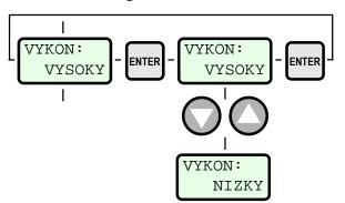
Úroveň výkonu VYSOKÝ odpovídá přibli•ně výkonu 3W v pásmu 3,5 MHz a 3W PEP v pásmu 144 MHz, úroveň výkonu NÍZKÝ odpovídá výkonu 0,9W v pásmu 3,5 MHz a 0,7 W PEP v pásmu 144 MHz.
